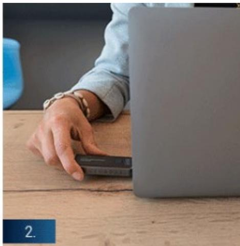
2. Collegare il trasmettitore alla porta HDMI del proprio PC. Come opzione, anche alla porta USB (alimentazione aggiuntiva). Il trasmettitore e ricevitore creano automaticamente il collegamento.
